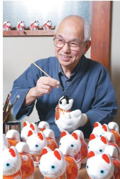
仕上げに面相を描く。目の周りに薄紅のぼかしを入れ、耳を赤のエナメルで塗り、胡粉に青色を混ぜた目の縁取りをとって、口、眉、鬚を面相筆で描き入れた後、黒のエナメルを使い、竹の棒を使って突くように瞳を描き入れ、最後に頭と足を塗る。(自宅作業場にて)
